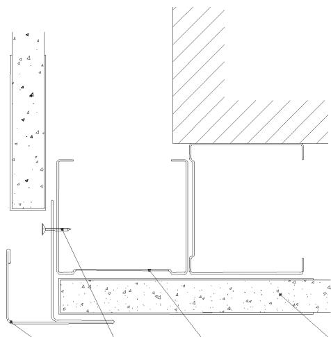
F-профиль Саморез Металлопрофиль
